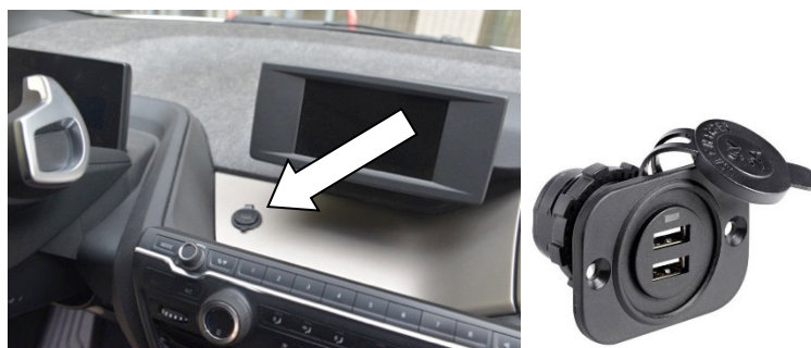
Figura 6 - Presa USB dedicata per navigatore satellitare sempre alimentata
