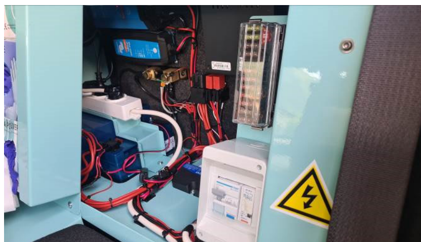
Figure 18, 19 – Alloggiamento impianto elettrico ausiliario e magnetotermico
